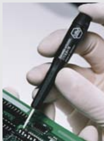
Trzon ceramiczny i rękojeść są trwale antymagnetyczne i antystatyczne.
