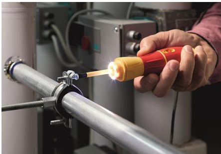
Bei kräftigeren Verschraubungen ist die Materialschutz-Stufe mit 1,0 Nm zu wählen.
