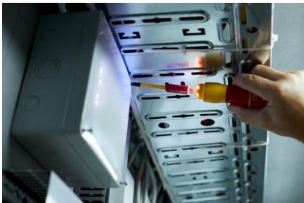
Mit dem E-Schraubendreher ist von Hand nur noch das manuelle Festziehen der Schraube am Ende notwendig – der restliche Schraubvorgang erfolgt automatisch.
