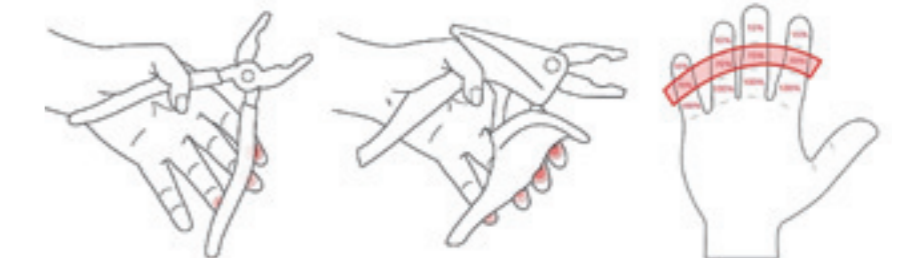
Die Inomic®-Zangengriff-Ergonomie überträgt die Handschließkraft gleichmäßig auf die Fingermittelglieder (70 Prozent).
